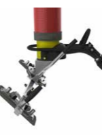
弯曲把手及板材角度 吸盘 610620 适配接头610810和 角度适配接头把手 610811
