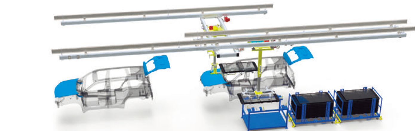
全景天窗安装
